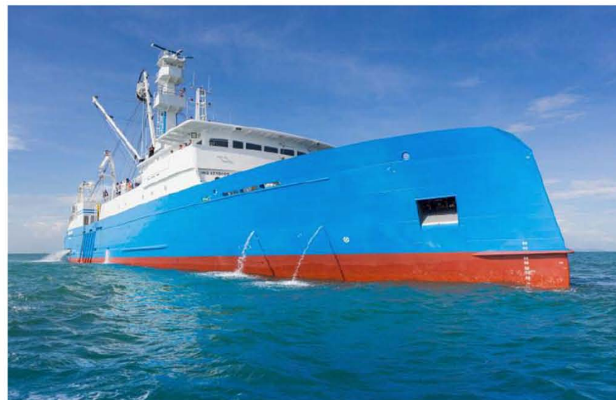
Ce thonier de 80 mètres se distingue par son design innovant, notamment son étrave inversée. (photo : Piriou)
